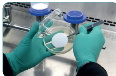
4. Перенесите мембранный фильтр в питательную среду, инкубируйте, посчитайте число микроорганизмов.
