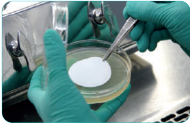
4. Перенесите мембранный фильтр в питательную среду, инкубируйте, подсчитайте число микроорганизмов.
