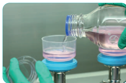
2. Добавьте тестируемый образец и начните фильтрацию
