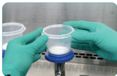
1. Установите основание, мембранный фильтр и воронку.
