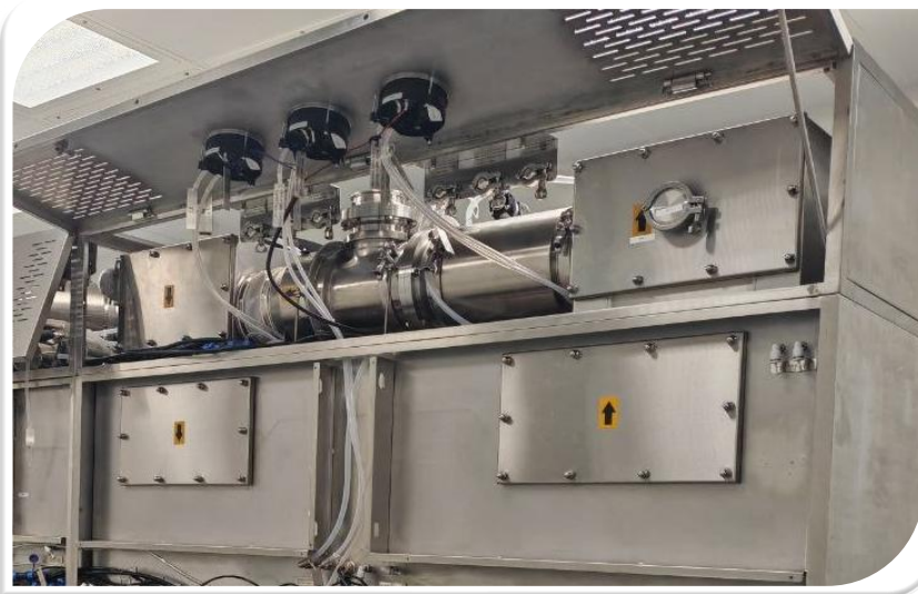
Система фильтров классического асептического изолятора
